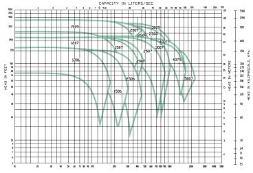
FLOW IN GALLONS PER MINUTE • 3500 RPM • FI QUICK SELECTION CURVE
